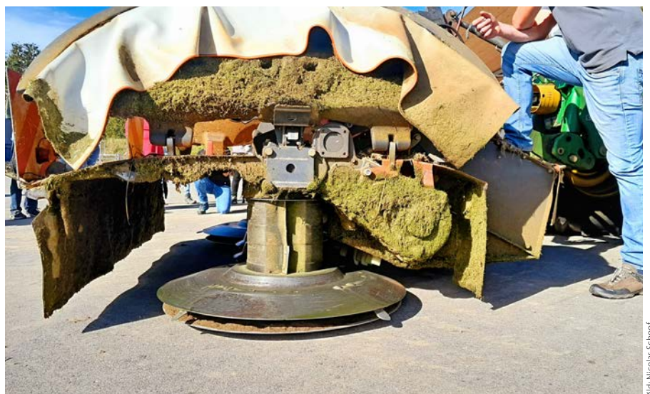
Abb. 2: Die Schnitthöhe moderner Mähgeräte (hier ein Trommelmäherwerk) lässt sich bereits über die Hydraulik des Geräteträgers einstellen. Aufwendiger ist die Anpassung durch den Einsatz anderer Auflagen (Kufen, Gleitteller).
