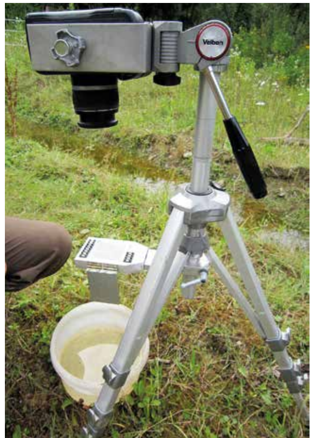
Abb. 2: Der „Bombinograph“ – Apparatur zur Aufnahme der Gelbbauchunken (nach B. SCHEEL).
